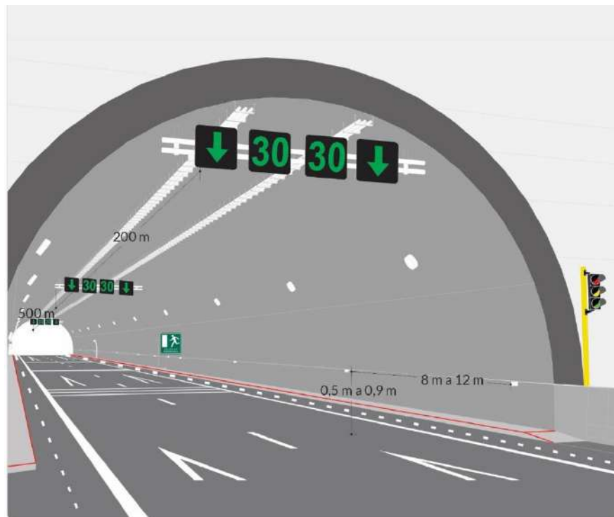
Figura 2-84. Esquema de señalización dentro del túnel
