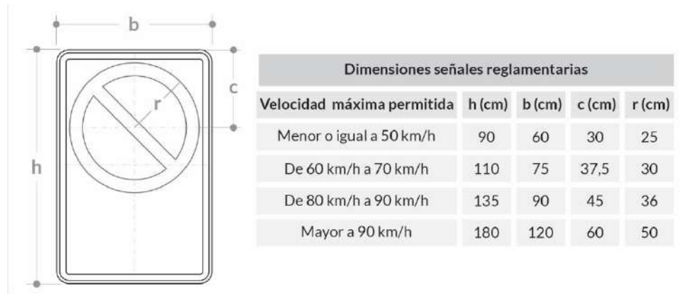
Figura 2-18. Dimensiones señales reglamentarias (con leyenda)
