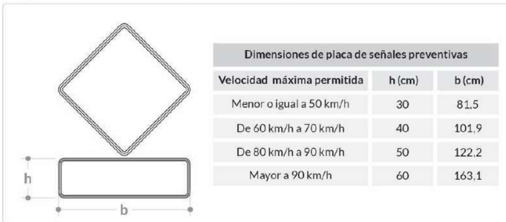
Figura 2-25. Dimensiones de placa de señales preventivas
