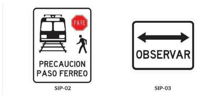
Figura 6-2. SIP-02 Paso de vía férrea. SIP-03 Observar riesgo en cruce
