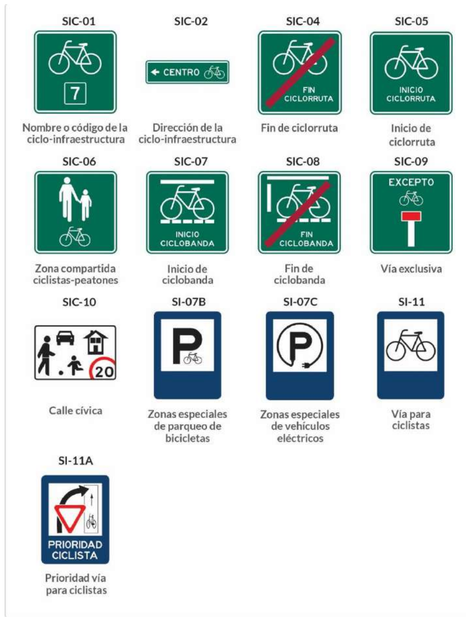
Figura 6-25. Señales informativas para ciclo infraestructura
