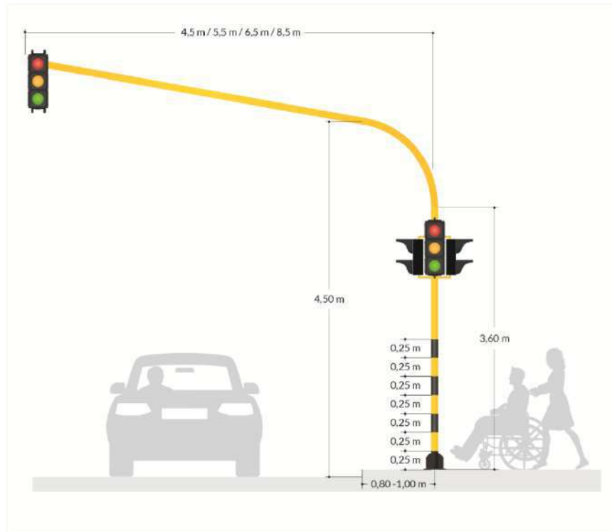
Figura 4-3. Postes tipo ménsula para el soporte de semáforos sobre la vía
