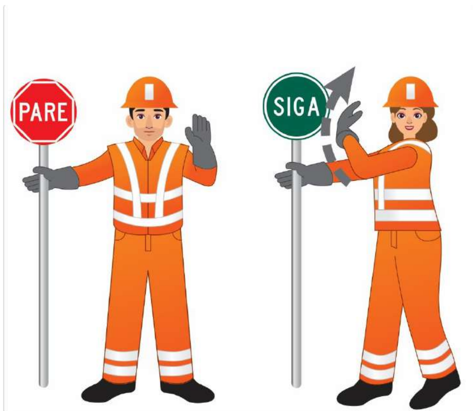
Figura 7-22. Auxiliar de tránsito
