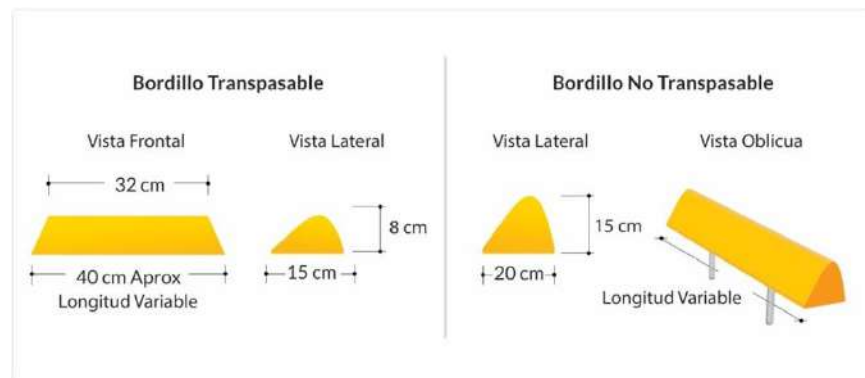
Figura 5-6. Dimensiones de bordillo
