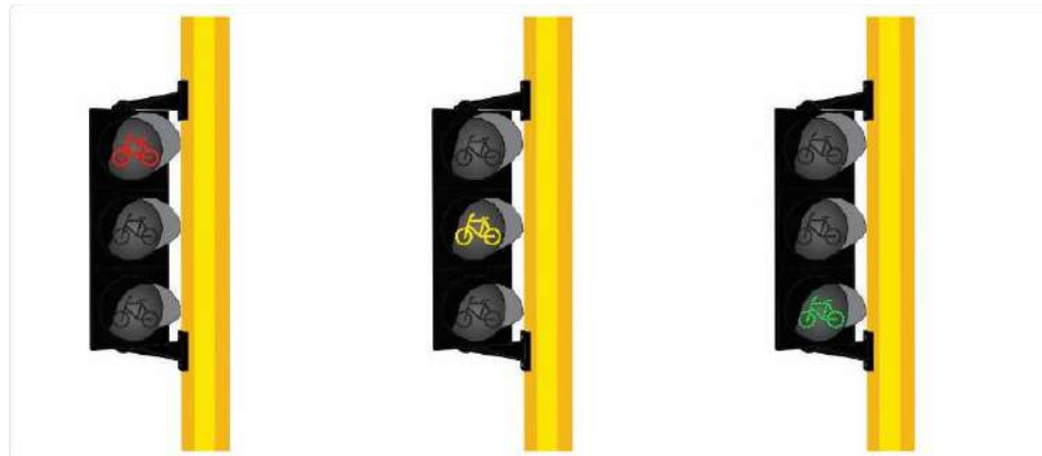
Figura 6-48. Indicaciones en semáforos para ciclistas
