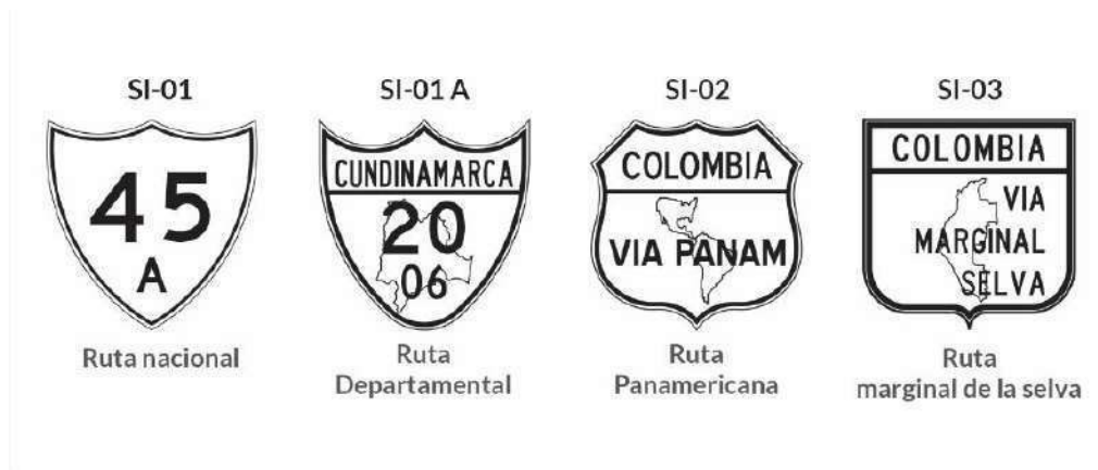
Figura 2-55. Señales de identificación vial
