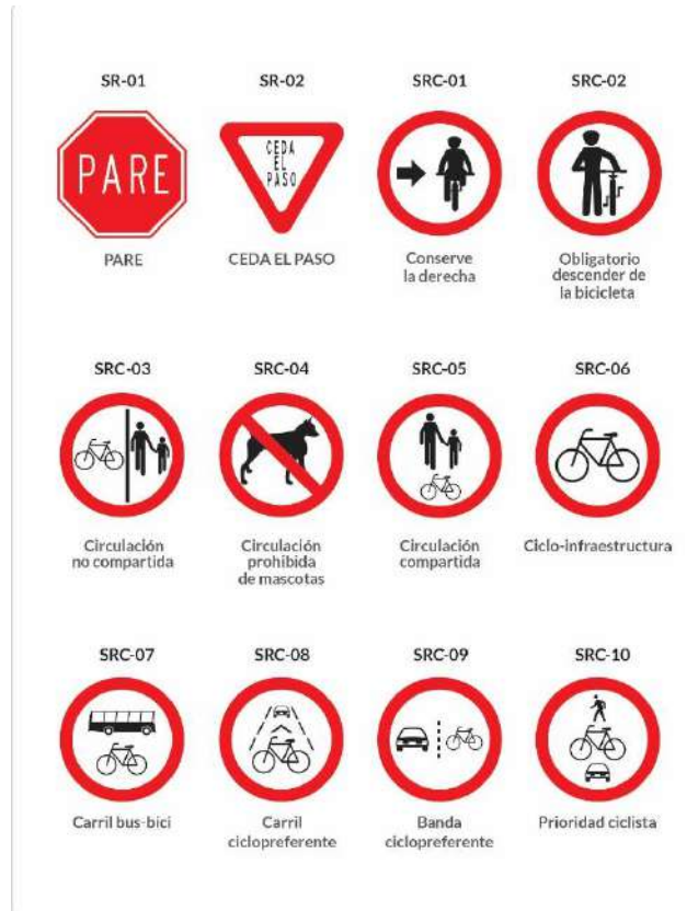
Figura 6-22. Señales reglamentarias para ciclo infraestructura
