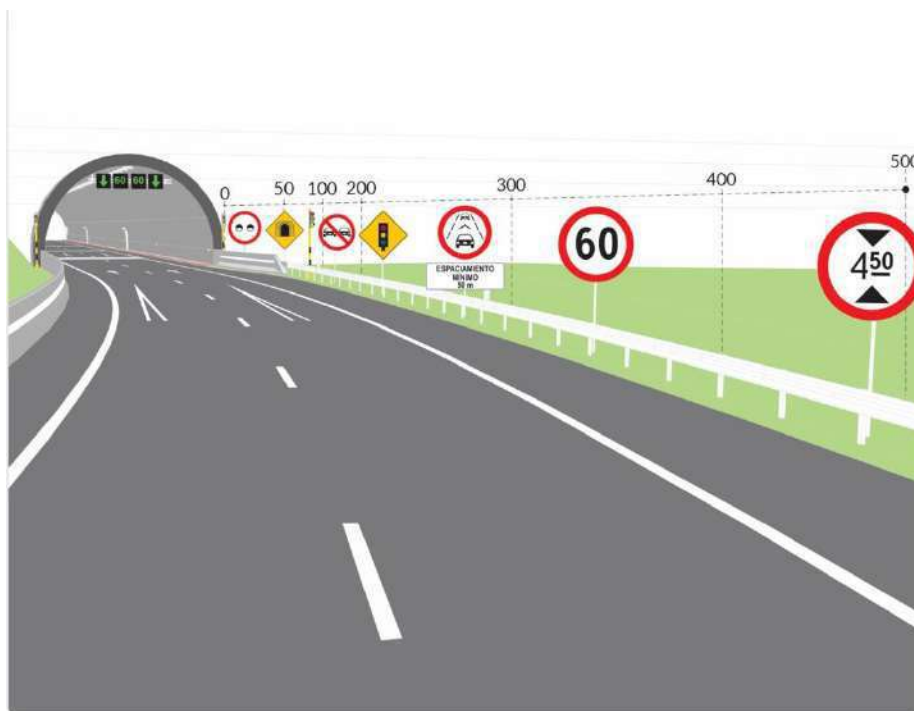
Figura 2-81. Señalización previa a túnel, con esquema mínimo
