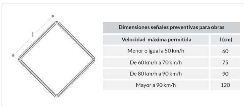
Figura 7-3C. Dimensiones señales preventivas para obras
