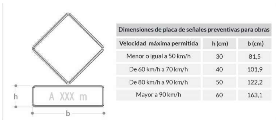
Figura 7-3D. Dimensiones señales preventivas para obras
