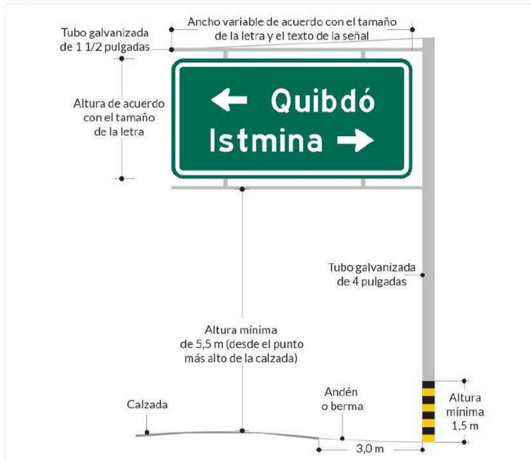
Figura 2-43. Sistema de soporte tipo bandera
