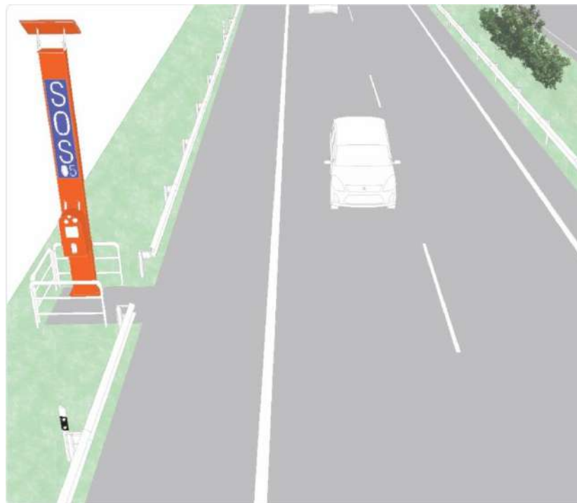
Figura 9-66. Ejemplo de localización y características externas de postes SOS
