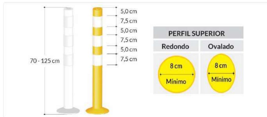
Figura 5-19. Dimensiones del delineador tubular simple
