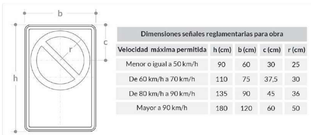
Figura 7-3B. Dimensiones señales reglamentarias para obras
