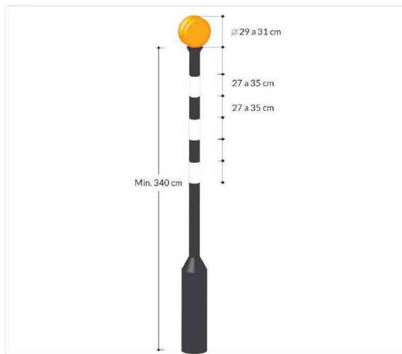
Figura 6-6. Especificaciones de la baliza iluminada elevada
