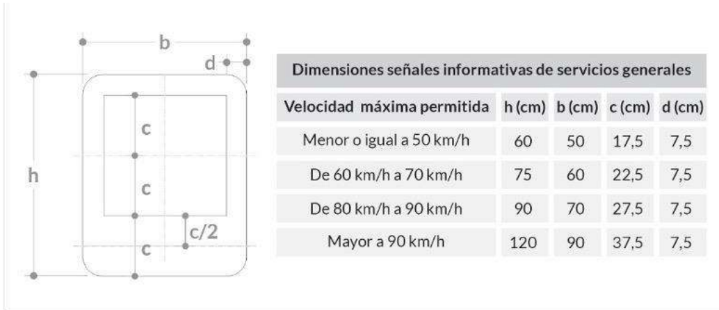
Figura 2-63. Dimensiones para señales de servicios generales
