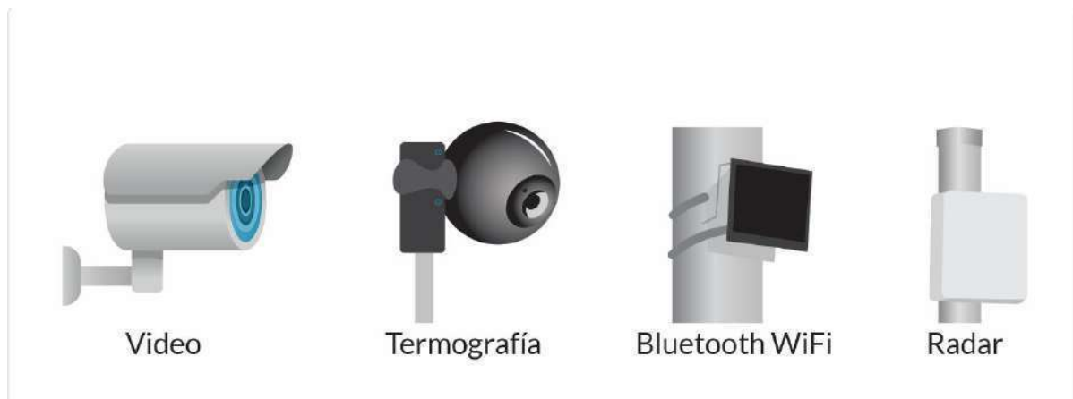
Figura 9-67. Elementos de detección típicos en sistemas ITS
