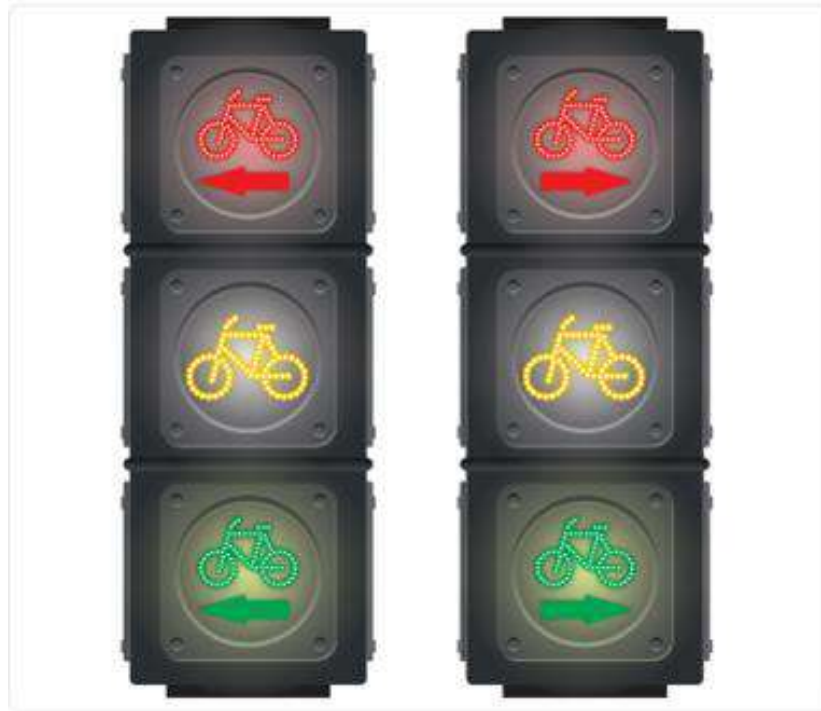
Figura 4-32. Simbología para la regulación de giros en semáforos para ciclistas
