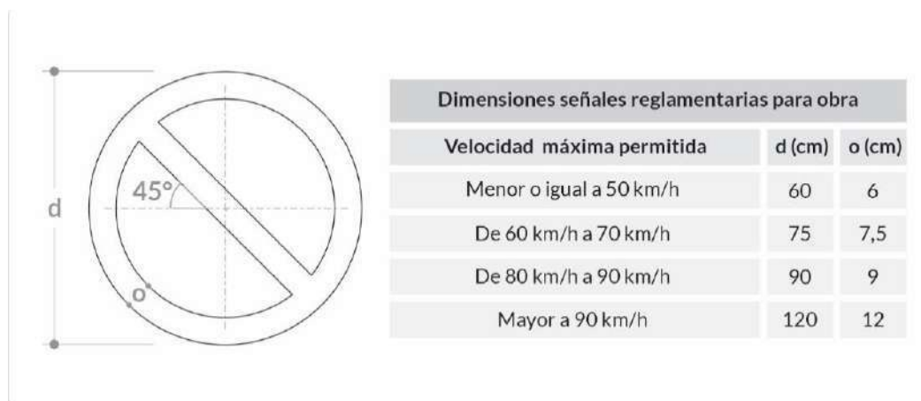
Figura 7-3.A. Dimensiones señales reglamentarias para obras
