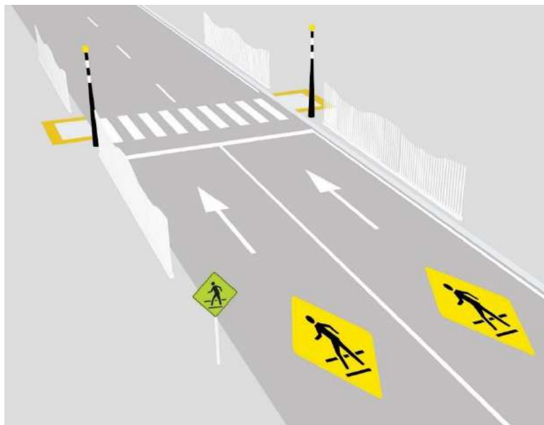
Figura 6-4. Paso cebra en tramo de vía
