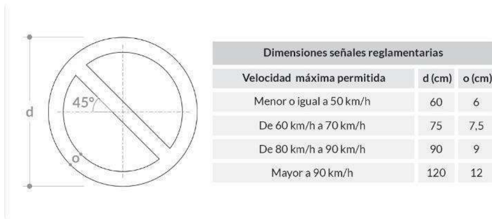
Figura 2-17. Dimensiones señales reglamentarias
