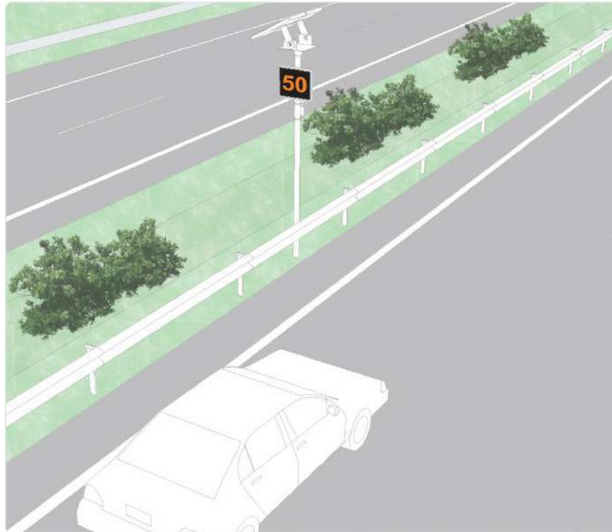
Figura 9-65. Ejemplo de localización y características externas de Radares pedagógicos para detección de velocidad
